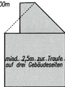
zurückgesetztes Dach mit unterschiedlichen Dachneigungen
